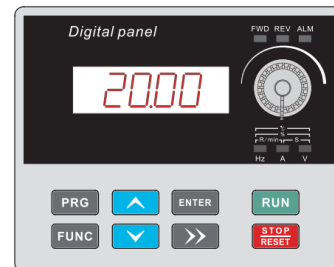
Отображение параметров при работе (На экране отображается текущая выходная частота 20,00)
