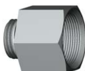
Адаптер для защитного шланга Pg9 / с трубной цилиндрической резьбой \frac{1}{2} " стандарта NPSM с числом витков на дюйм 14
